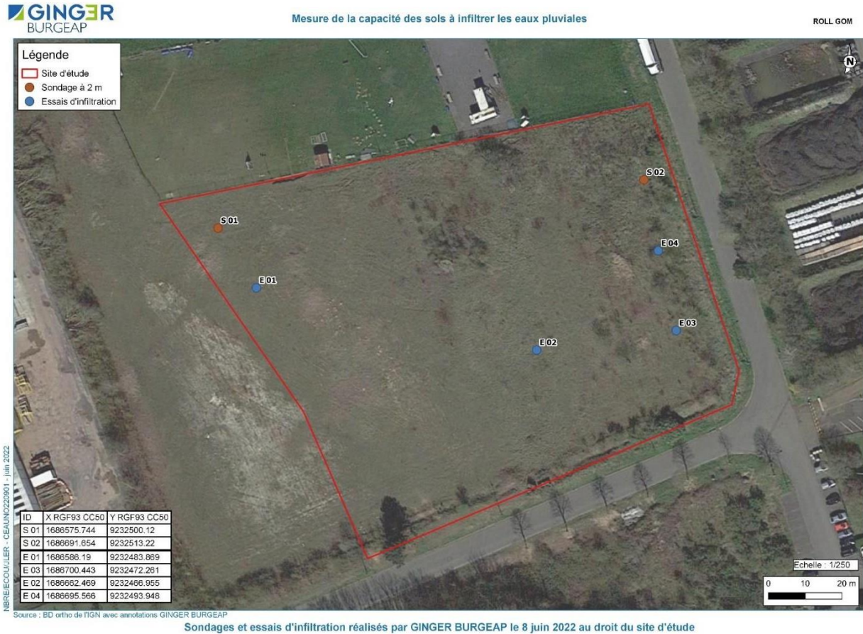
Figure 8 : Sondages de sol et essais d'infiltration réalisés par GINGER BURGEAP le 8 juin 2022 au droit du site d'étude (Source : BD Ortho de l'IGN avec annotations GINGER BURGEAP)
